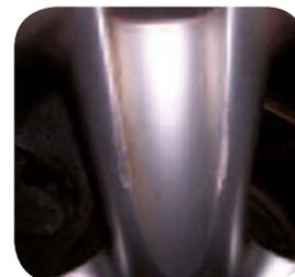
Arrachement de matière < 3 mm de profondeur et 40 mm de longueur : valorisation d'un forfait réparation.
