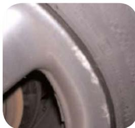
Arrachement de matière sur le bord de jante < 3 mm de profondeur et 40 mm de longueur : valorisation d'un forfait réparation.
