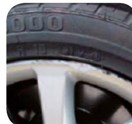
Arrachement de matière d'une profondeur > à 3 mm de profondeur sur le voile de jante : remplacement de l'élément.
