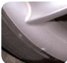
Déformation de la jante : pas de réparation possible. Remplacement de l'élément.
